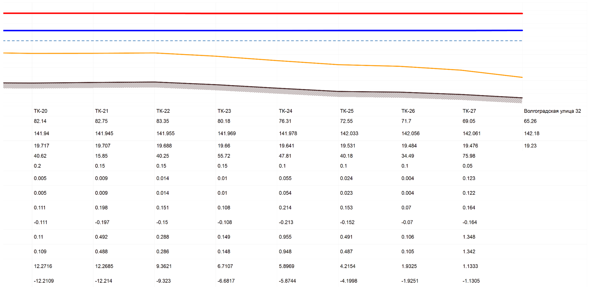
Рисунок 36. Пьезометрический график от котельной Куникова, 92 до потребителя по ул. Волгоградская, 32
