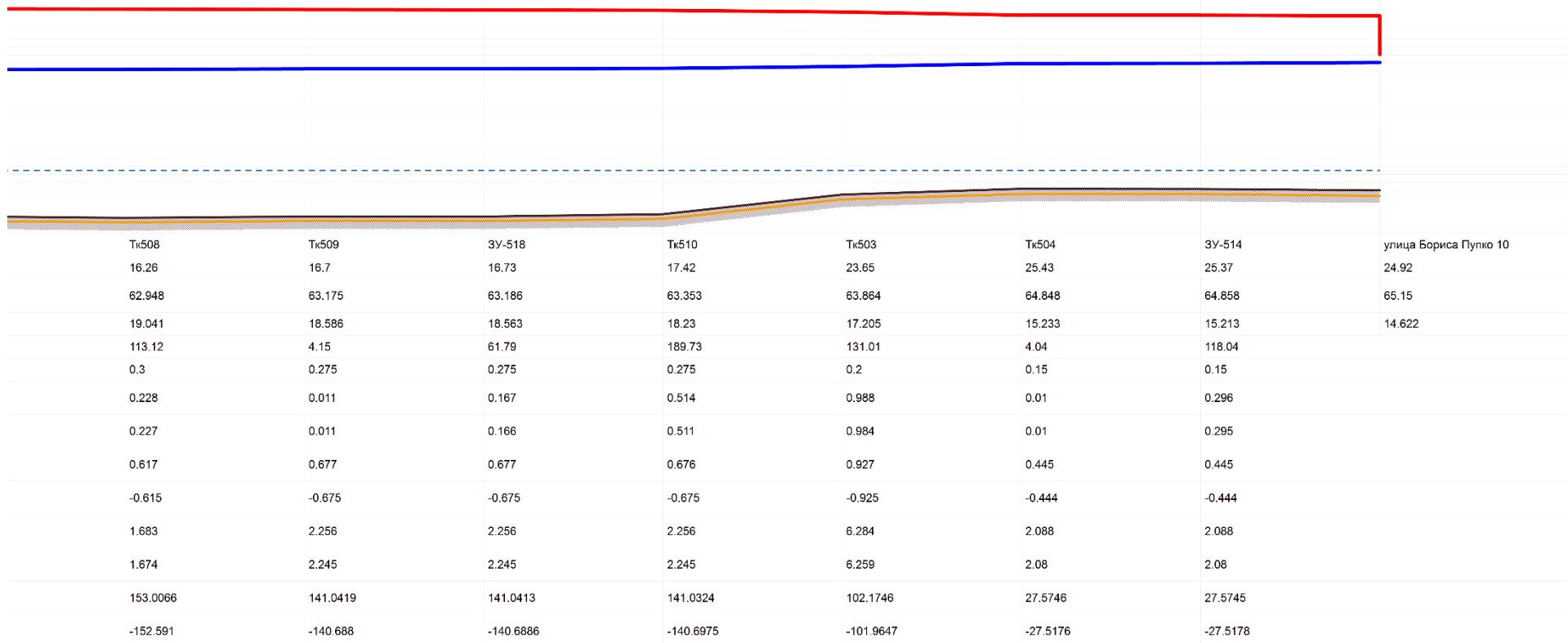
Рисунок 53. Пьезометрический график от котельной №11 «Краснодартеплосеть» до потребителя по ул. Бориса Пупко, 10
