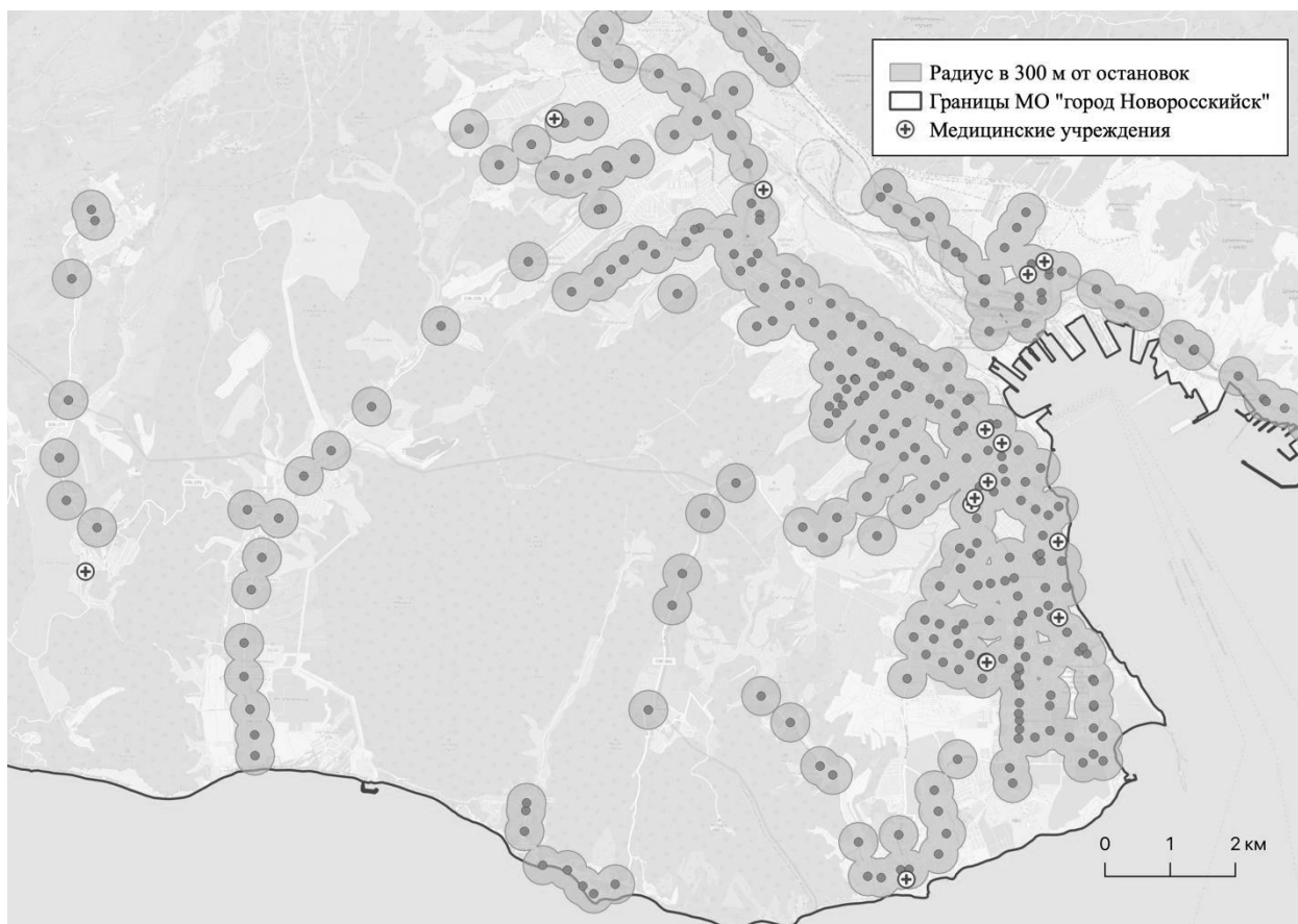
Рисунок 5.2.2.5 - Соответствие предельного расстояния 300 м кратчайшего пешеходного пути от границ участков объектов до остановочных пунктов (медицинские и социальные учреждения)
